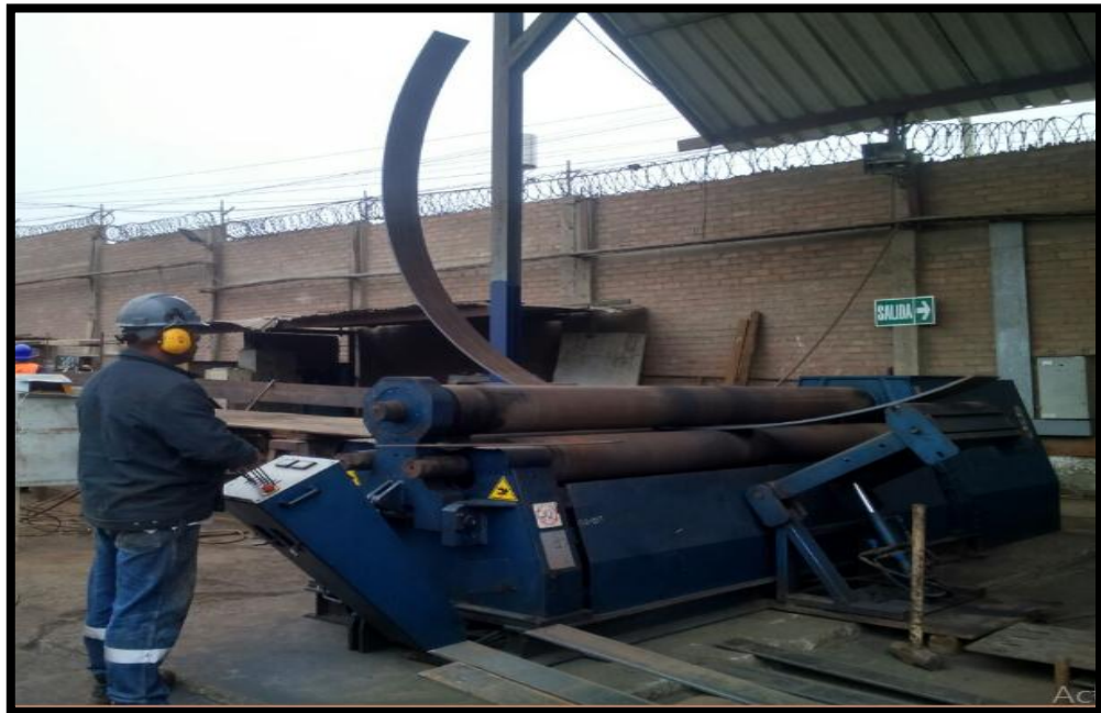
Figura 44 Proceso de rolado de planchas
