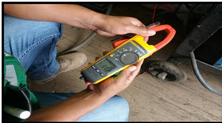
Figura 42 Medición de la tensión de soldadura
