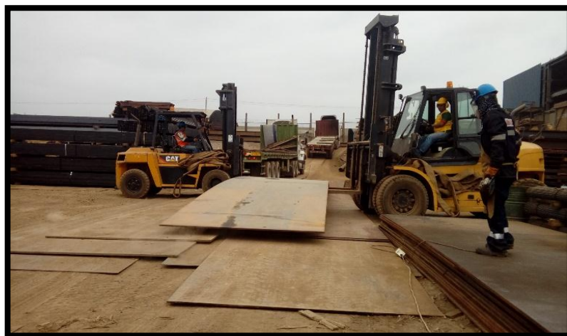
Figura 28 Recepción de planchas A-36
