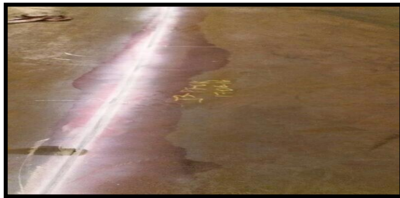
Figura 53 Ensayo de tintes penetrantes a planchas
