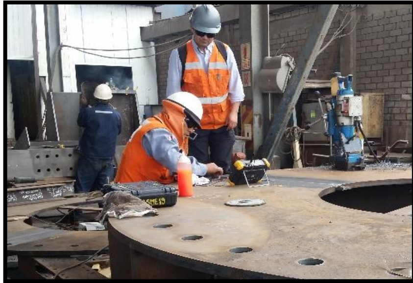
Figura 57 Aplicación de ensayo ultrasonido
