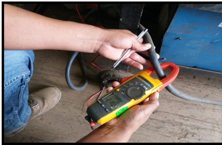
Figura 41 Medición de la corriente de soldadura
