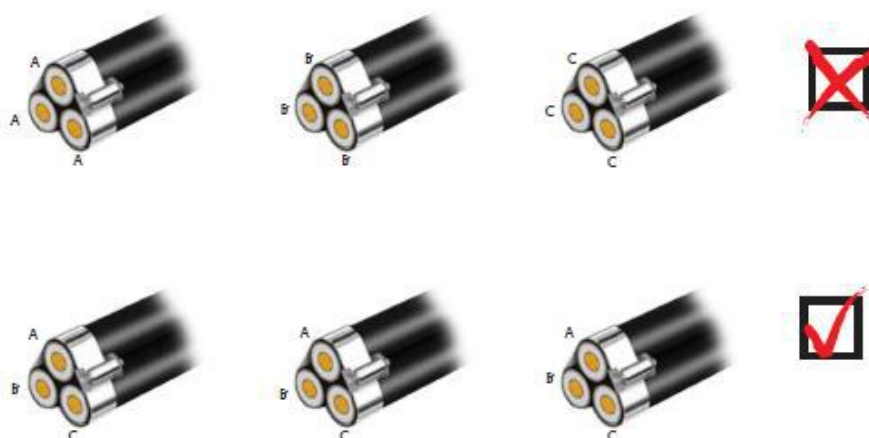
Figura 10: Instalación de cables para MT, tres conductores por fase. Fuente: Catalogo Centelsa.
