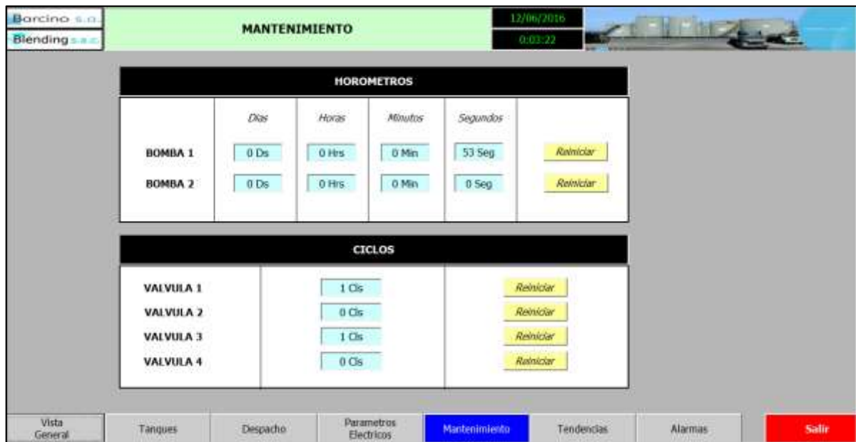
FIGURA 3.96: Pantalla SCADA – Mantenimiento
