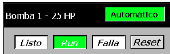
FIGURA 3.84: Electrobomba en estado: Run
