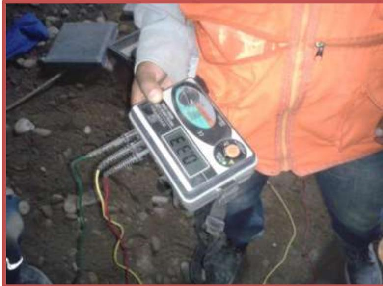
**FIGURA N° 16: Medición de la Resistencia con el Telurómetro
