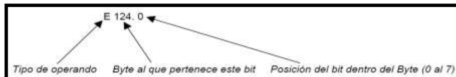
Figura N° 09: Especificación de un registro tipo Bit
