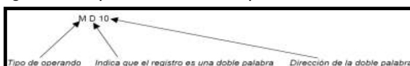
Figura N° 13: Especificación de la doble palabra MD10 en bits
