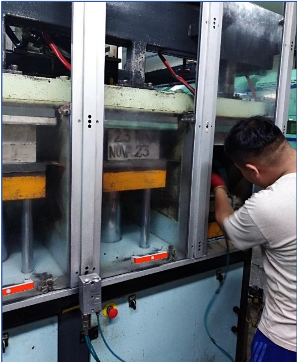
FIGURA 17: Calibración compuerta de moldes máquina I8L2
