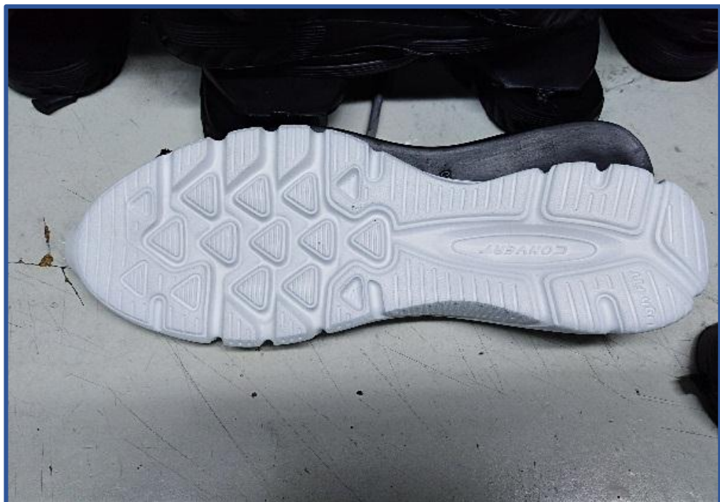
FIGURA 8: Suela después de la inyección material EVA
