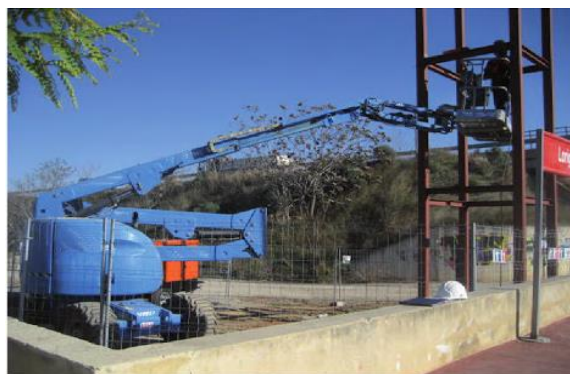
Figura N°1: Plataforma elevadora móvil de brazo articulado
