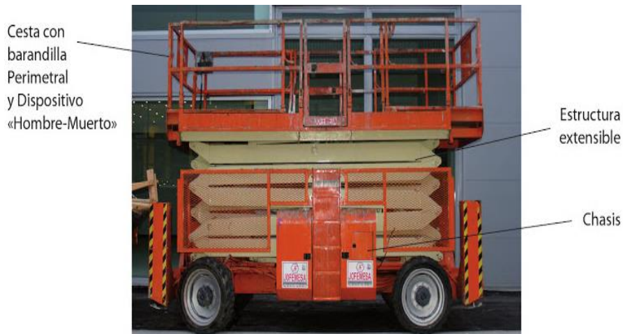
Figura N°2: Plataforma elevadora móvil de tipo tijera
