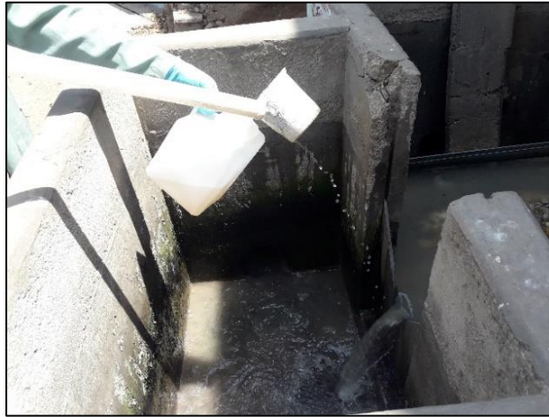
Figura 10. Toma de muestra en la zona de captación del CITRAR (2) Fuente: Elaboración propia
