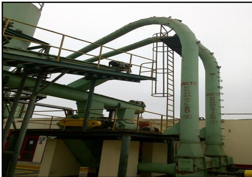
**Sistema Filtro Mangas para retener material particulado del enfriador N°1**
