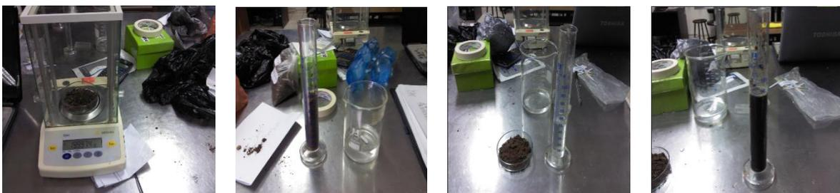
**Figura 36.** Medida de la densidad real en laboratorio.
