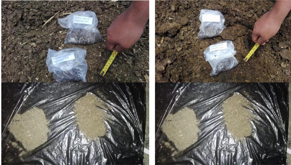
**Figura 31.** Toma de muestras superficiales y profundas, además de la mezcla compuesta en campo.
