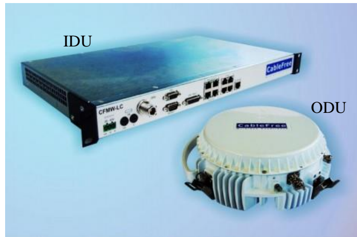
Figura 5. Sistema Split Mount. Fuente: (CableFree, 2014)
