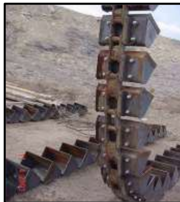
Figura 29. La cadena con cangilones
