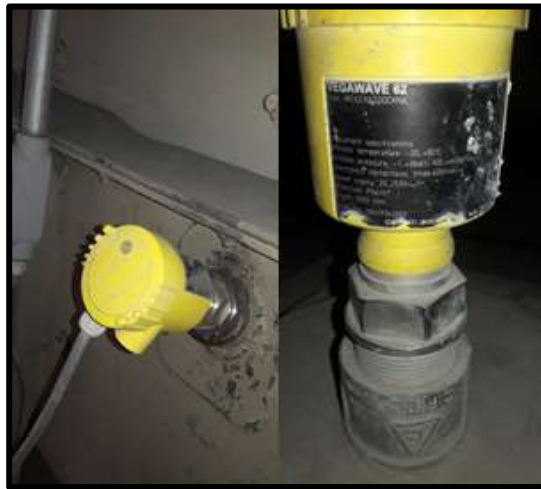
Figura 31. Sensor serie VEGAWAVE 62
