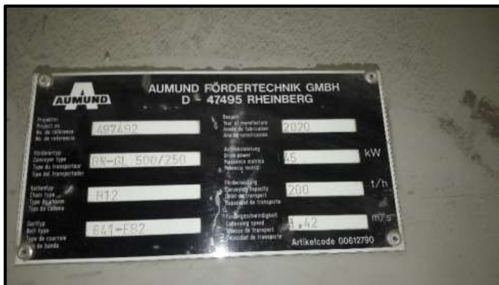
Figura 39. Datos técnicos del elevador de cangilones
