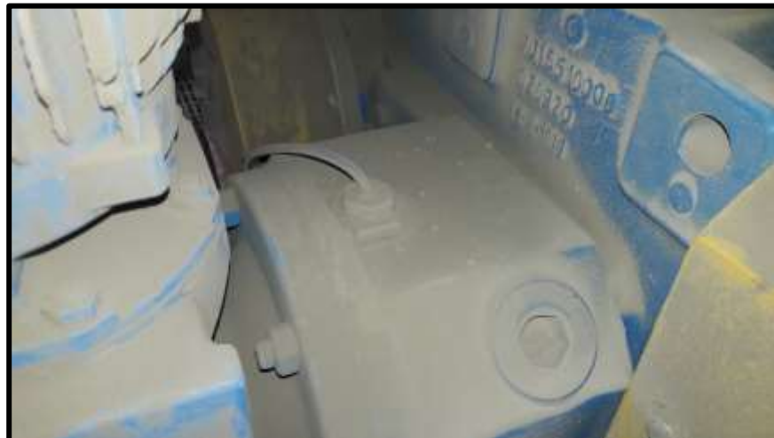
Figura 108. Ubicación del Transmisor de revoluciones turck
