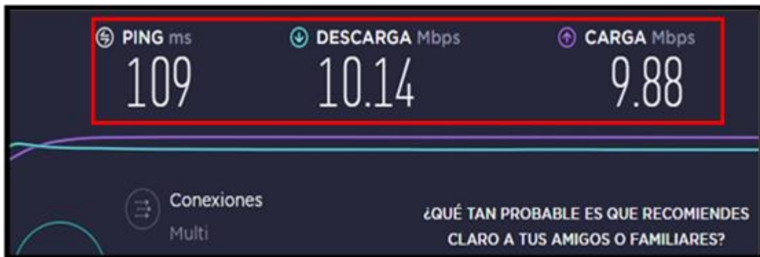
Figura 55 Prueba de test de Velocidad de cliente con última milla.
