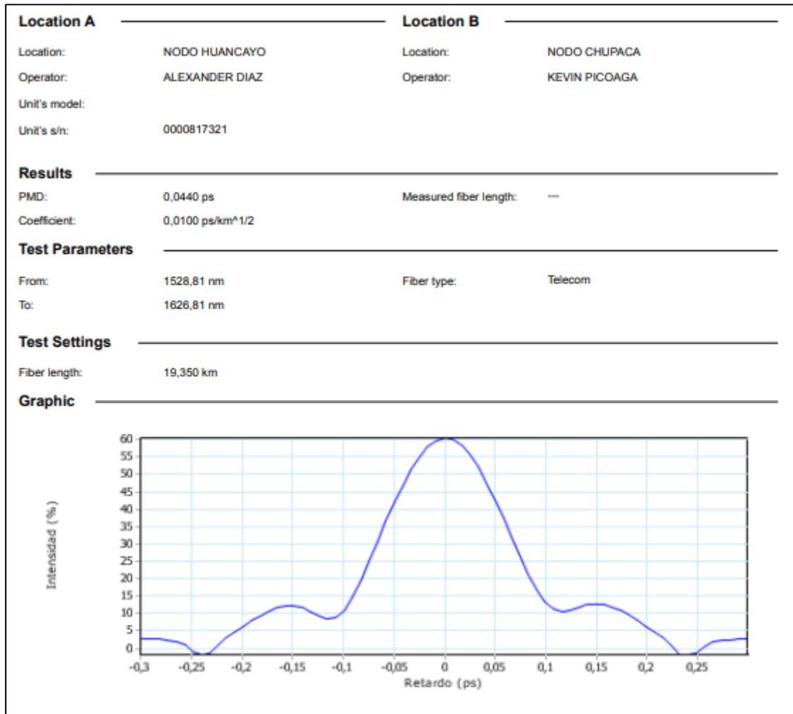
Figura 53. Prueba de Desviación Modal de Polarización
