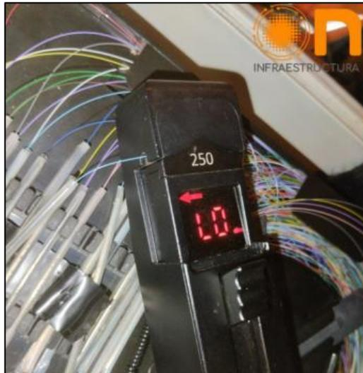
*Figura 44.* Medición de hilos con el Fiber Optical Identifier
