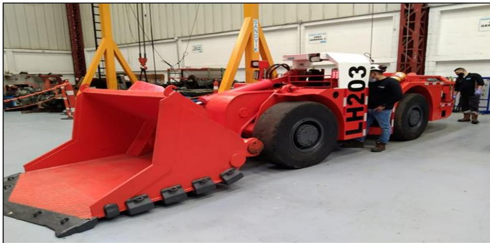
Figura 14. Equipo de bajo perfil Scooptrams LH203 de 3.5 TN.
