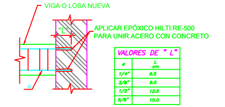
DETAILLE 1 DE ANCLAJE DE VIGAS
