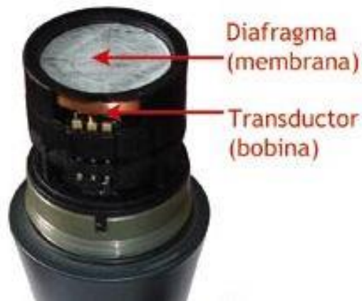
Figura 16 Partes esenciales de un micrófono Fuente: http://www.analfatecnicos.net/
