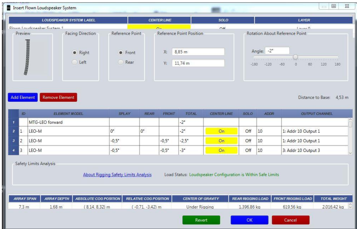
Figura 47 Ventana de configuración de line array . Fuente: Elaboración propia
