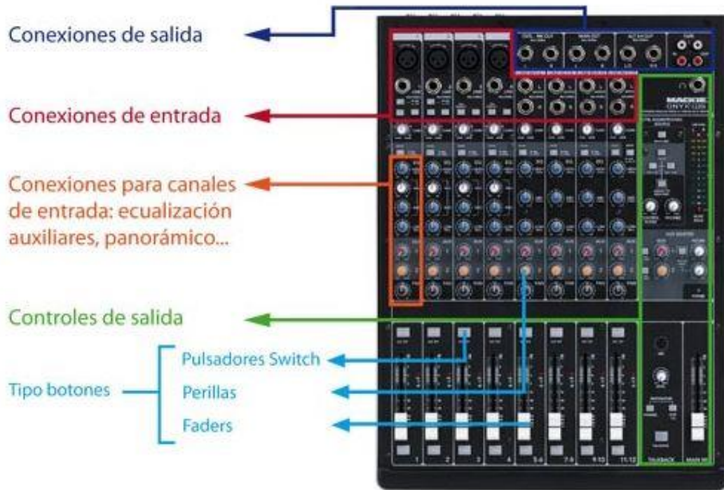
Figura 18 Partes de una consola Mackie Onyx 1220i Fuente: http://www.mackie.com/
