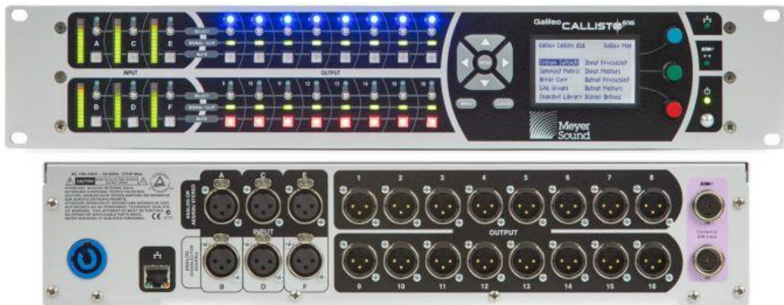
Figura 41 Panel frontal y posterior de galileo calisto 616. Fuente: http://www.meyersound.com/
