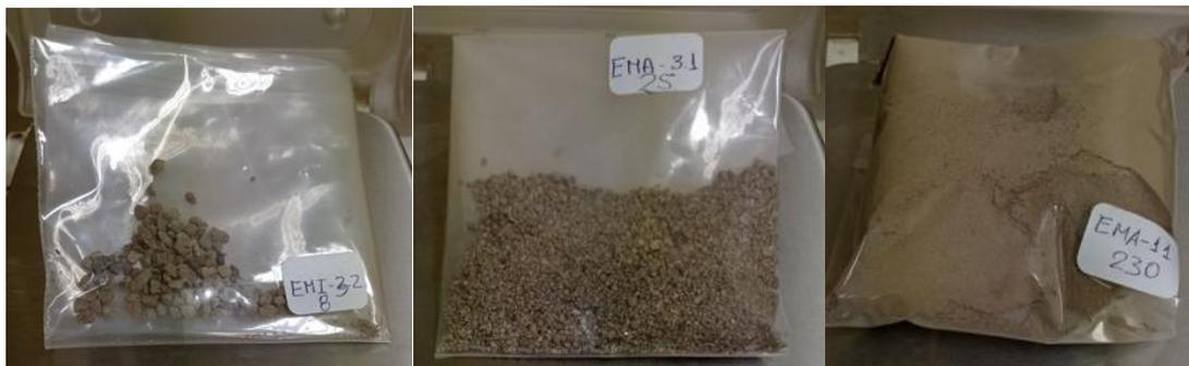
Posteriormente, se somete a un proceso de secado a 70°C por 12 h para determinar el peso de la muestra seca.
