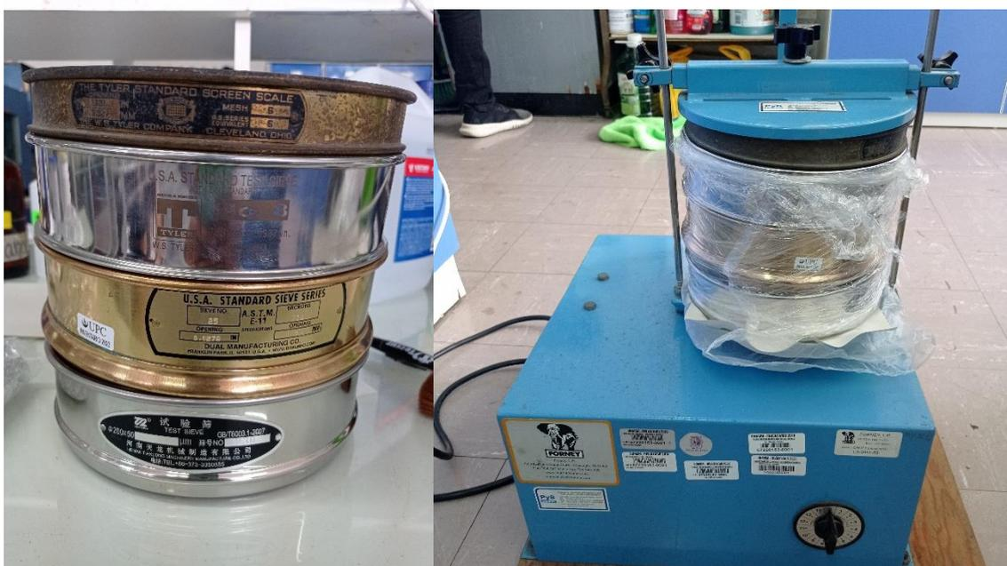
Se pasaron las muestras de sedimentos fluviales por la columna de tamices ajustados a la agitadora por un tiempo de 10 min. cada una.
