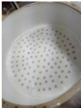
Para completar el sistema de filtrado al vacío que se aplicará para la recuperación de microplásticos, previamente se armó el sistema compuesto por el embudo Büchner el cual fue acoplado herméticamente con un tapón de goma a un matraz Kitasato, y este fue conectado desde su toma lateral, a través de un tubo de silicona, a una Bomba de alto rendimiento, 220 V/50 Hz ®Milipore.
