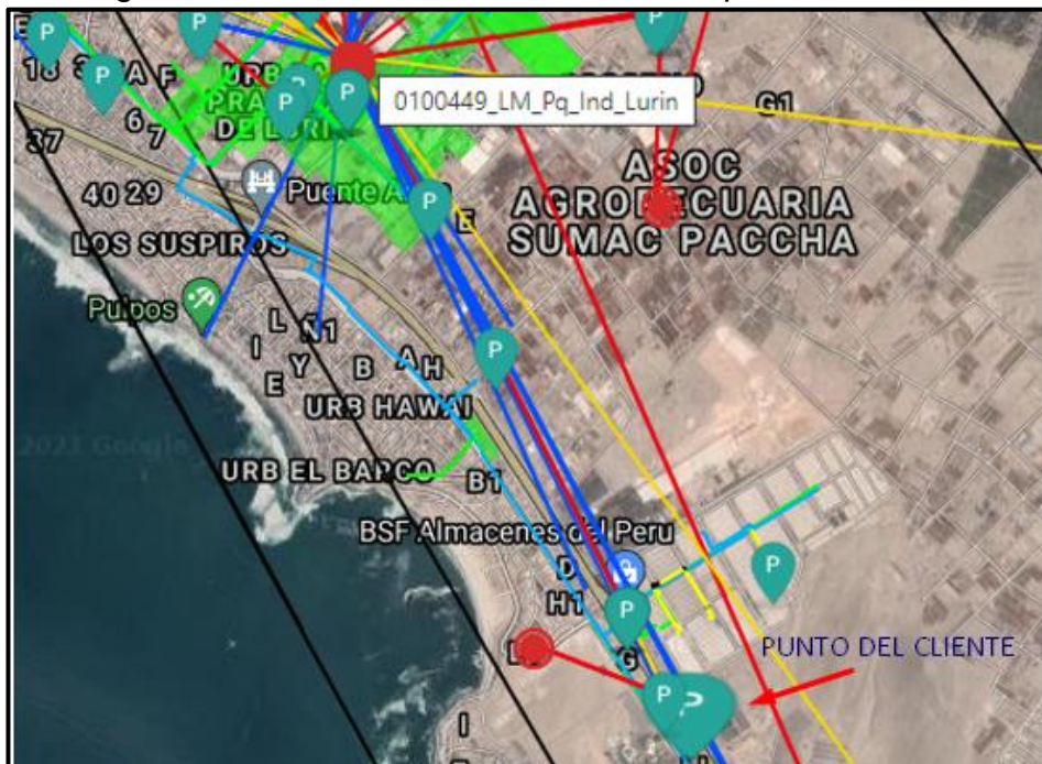
Figura 46. Recorrido de la fibra desde el punto del cliente
