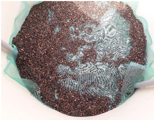
Fotografía 11. Material de empaque gravilla o grava confitillo de 3/8"
