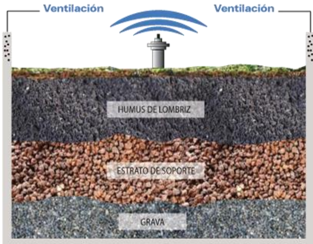
Figura 14. Modelo de Biofiltro o Lombrifiltro de la Técnica Tohá (Sistema Tohá, 2013)
