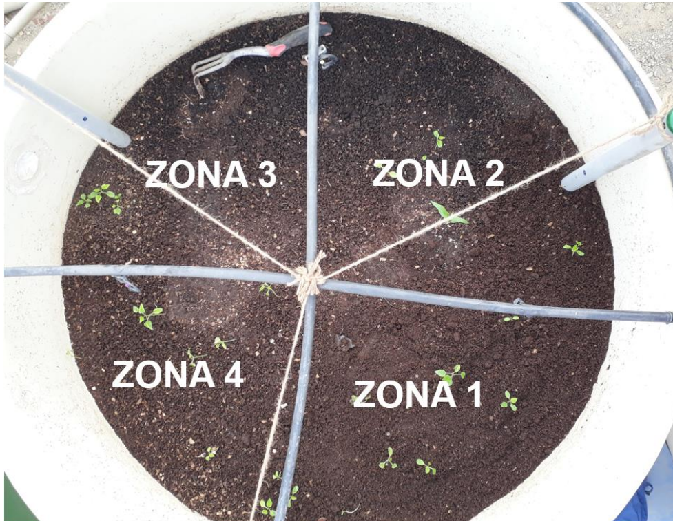
Figura 31. Zonas o cuadrantes del lombrifiltro
