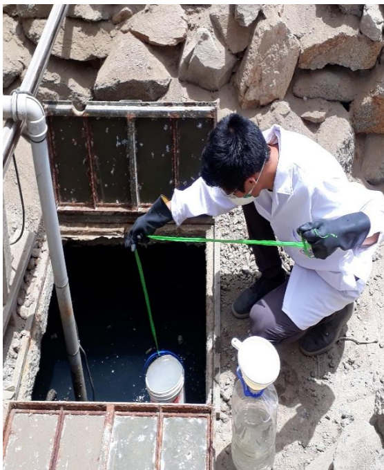
Fotografía 7. Recolección de aguas residuales del pozo séptico
