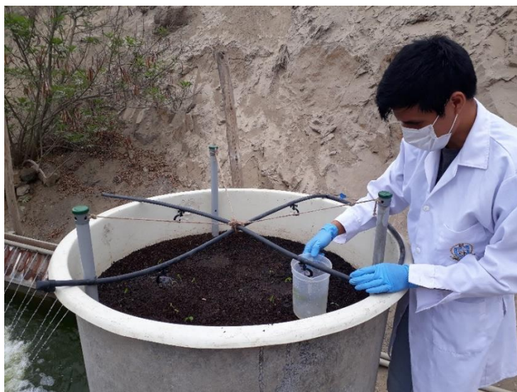
Figura 25. Método volumétrico para determinar el caudal de operación.
