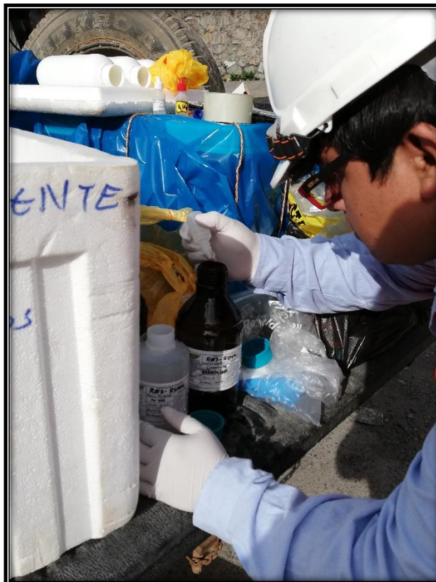
Fotografía N° 14: Aplicación de preservantes para el Laboratorio R-Lab.
