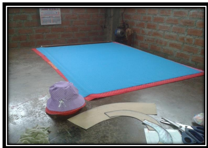
Imagen Nro. 04: Tendido de la Tela para los gorros El “Zapallito”
