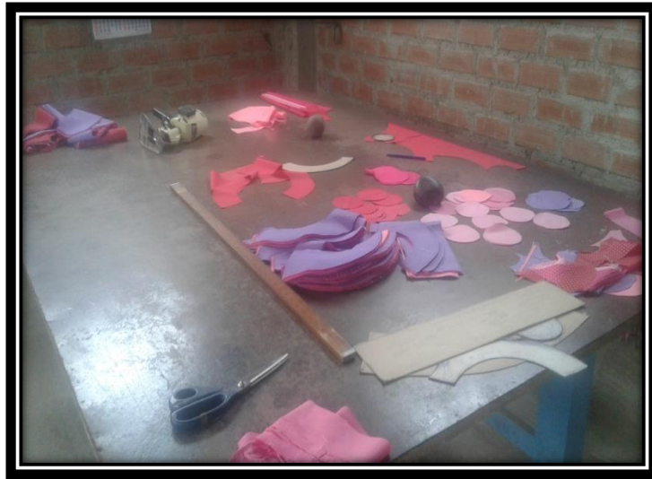
Imagen Nro. 07: Corte de Tela para los gorro El “Zapallito”
