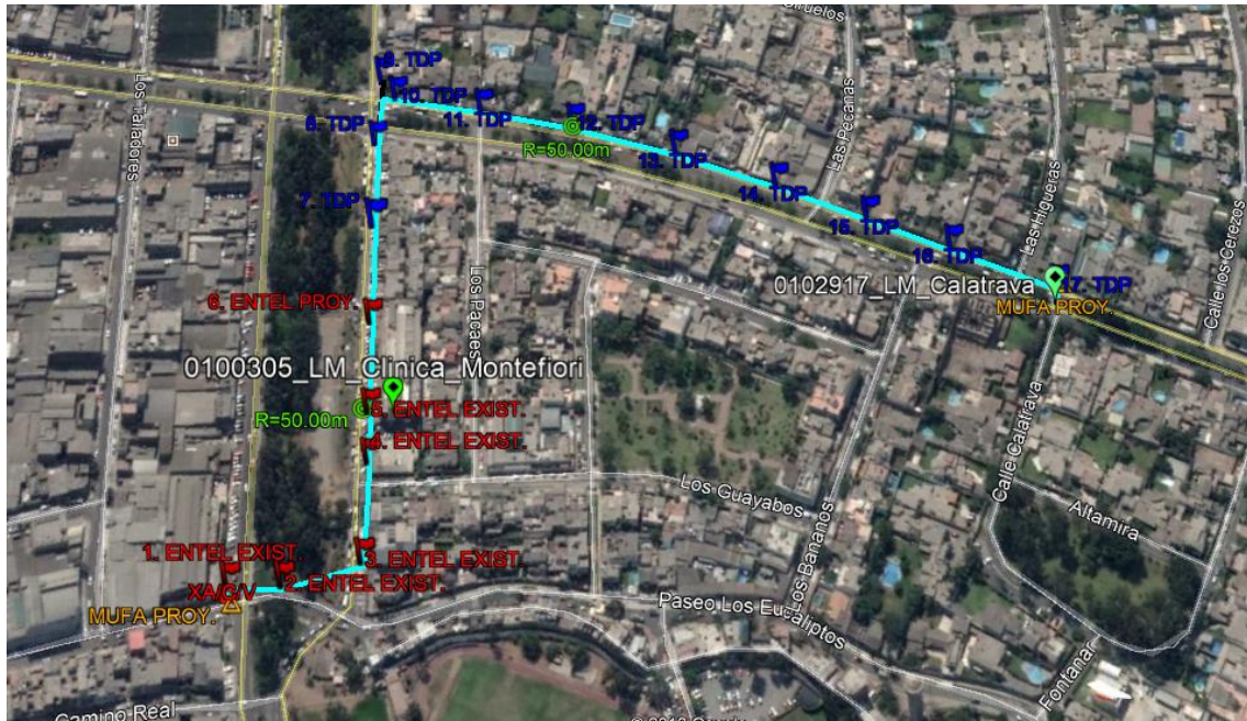
Figura 14: Este plano se elaboró en Google Earth Pro con la finalidad de visualizar el recorrido de la fibra óptica.
