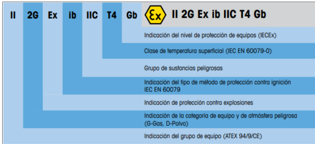
Figura 12. Marcado típico de equipos eléctricos conforme a ATEX 94/9/CE Fuente: Estándares y normativas para zonas peligrosas, Toledo (2004)
