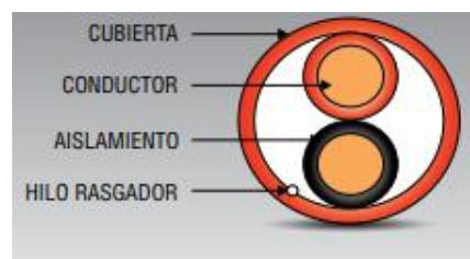
Figura 23. Partes del cable FPLR Fuente: FPLR 2C/16 AWG (2014, VIAKON)
