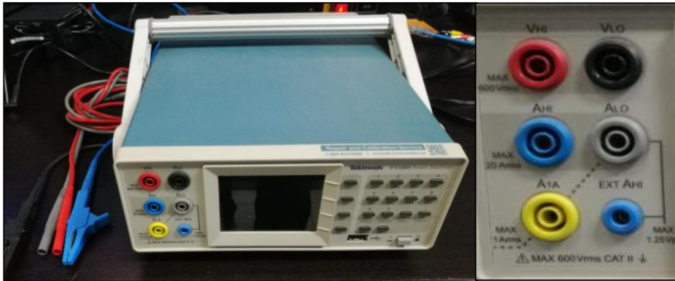
Figura 21: Analizador de corriente y entradas de conexión
