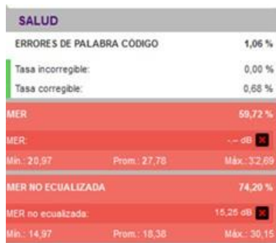
Figura 17: Sistema XperTrak calculando el MER del nodo.
