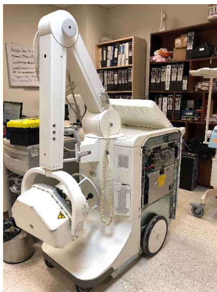
Figura 12: Desmontaje del equipo Rayos X Portátil para mantenimiento preventivo
