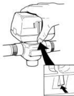
Figura N°3.2. Ubicación del abridor manual de la válvula Solenoide.
