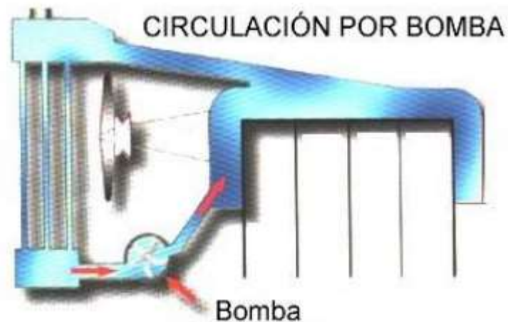
Figura N°2.2. Sistema de circulación por bomba
