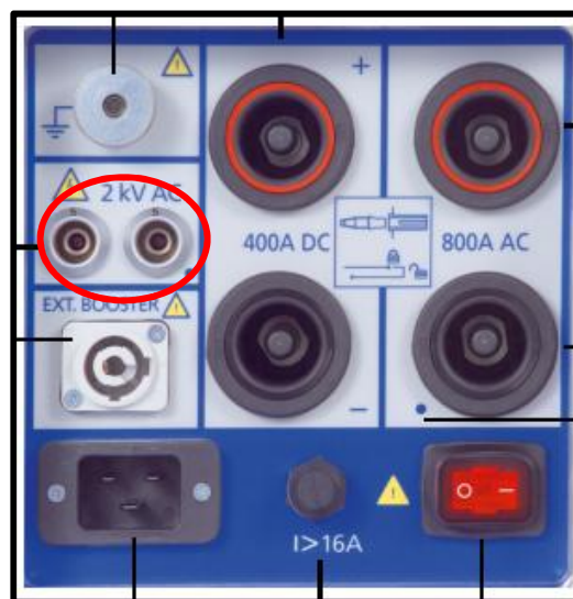
Figura 33 - Salidas de Tensión para prueba hasta 2KV AC. Fuente: CPC-100 Reference Manual
