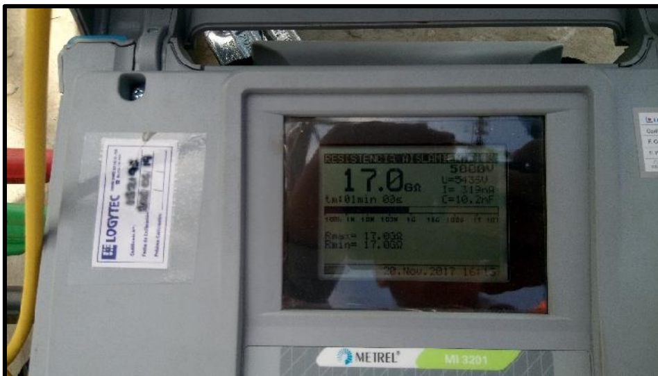
Figura 62 - Resultado de Resistencia de aislamiento de Alta a Baja
