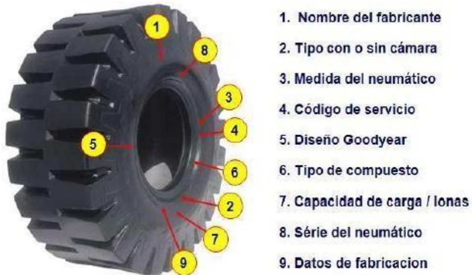
Figura 5. Nomenclatura en los neumáticos
