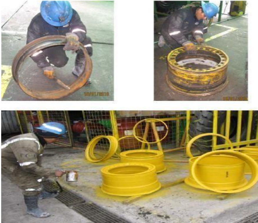
Figura 11. Inspección y pintado a los accesorios de seguridad
