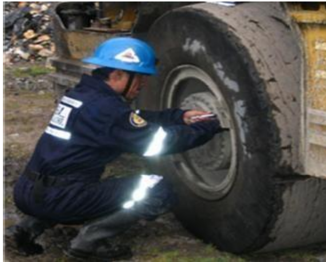
Figura 16. Inspección de presiones
