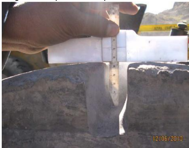
Figura 17. Inspecciones de profundidad de cocada
