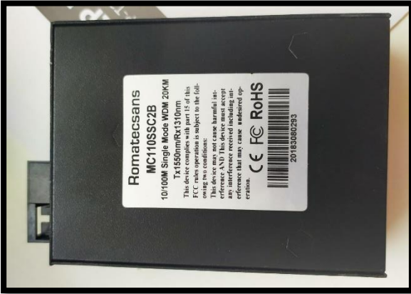
Figura 43: Especificaciones técnicas de la Media Converter Romatecsans
