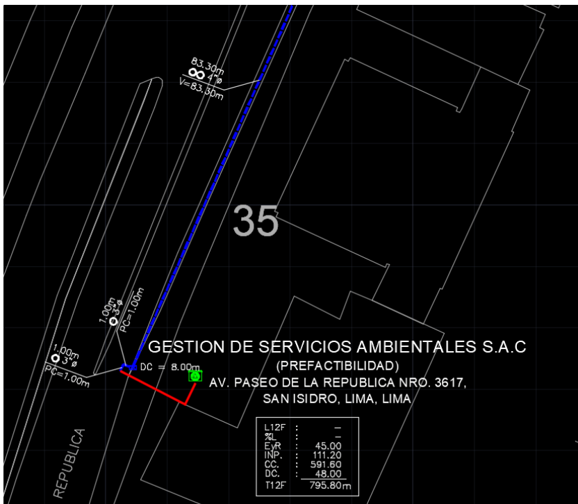
Figura 3: Canalizado proyectado hacia local del cliente.
