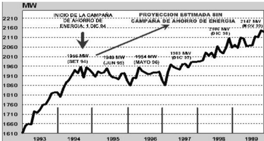
Figura 2.8 Evolución de la Máxima Demanda en el Sistema Interconectado Centro – Norte (SICN) desde 1993 hasta 2000 Fuente: Estudios de Eficiencia Energética
