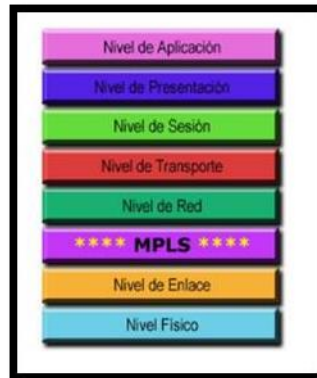
Figura 2: Descripción de la ubicación de MPLS en el modelo OSI Fuente: Pagina web capas del Modelo OSI
