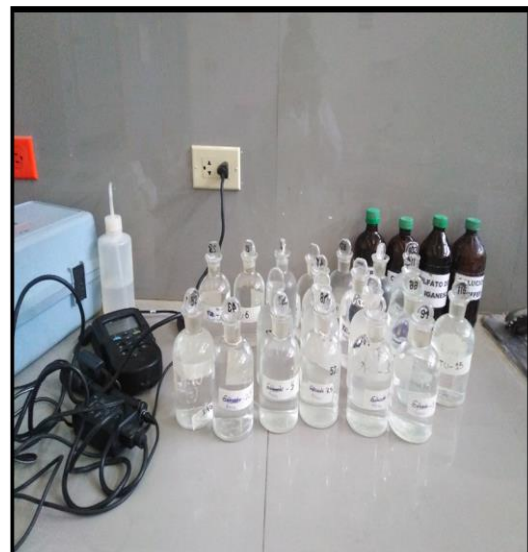
Figura 38. Preparación del agua con nutrientes y su posterior inoculación de la muestra en los frascos Winkler.
