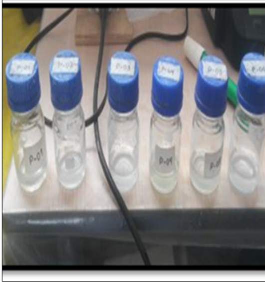
Figura 28. Botellas rotuladas del 1 al 6, los cuales representan las dosis (40, 70, 90, 110, 130, 150 mg/L respectivamente).
