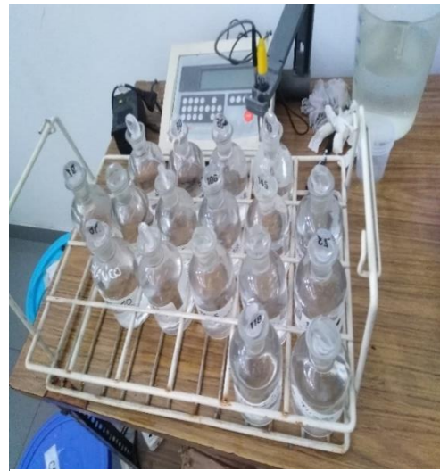
Figura 40. Frascos Winkler después de haber salido de incubación por 5 días.
