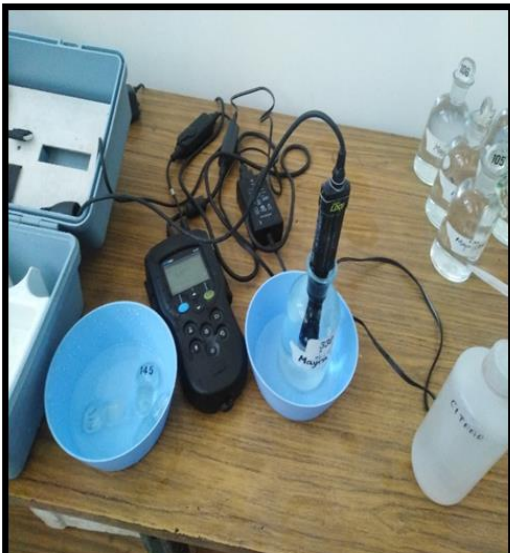
Figura 39. Medición de OD del coagulante natural Opuntia ficus-indica.
