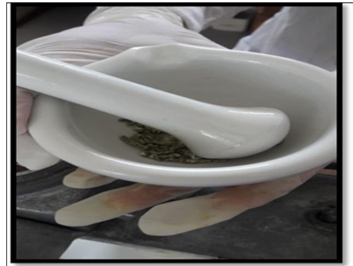
Figura 24. Trituración de las tiras de la penca de Tuna, después de haber ido al horno.
