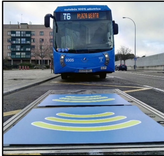
Figura N° 7: Recarga de un bus eléctrico por inducción 9
