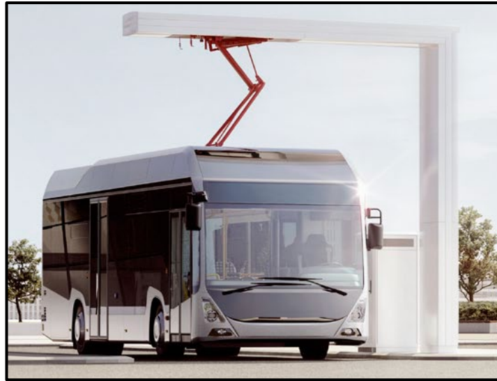
Figura N° 6: Recarga de un bus eléctrico mediante un Pantógrafo 8
