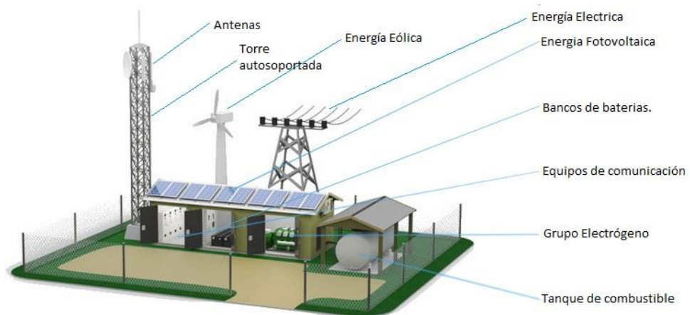
Figura 19: Elementos que componen una EBT.
