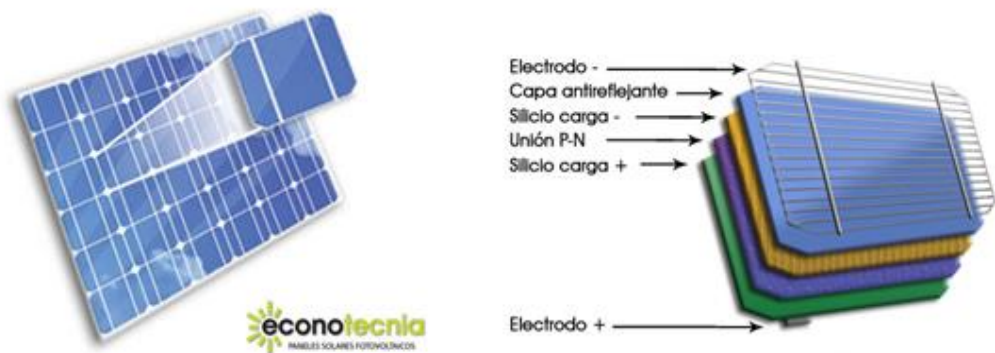
Figura 2: Célula Solar Fotovoltaica.
