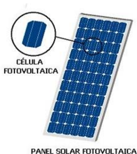
Figura 3: Esquema de la composición de un panel.
