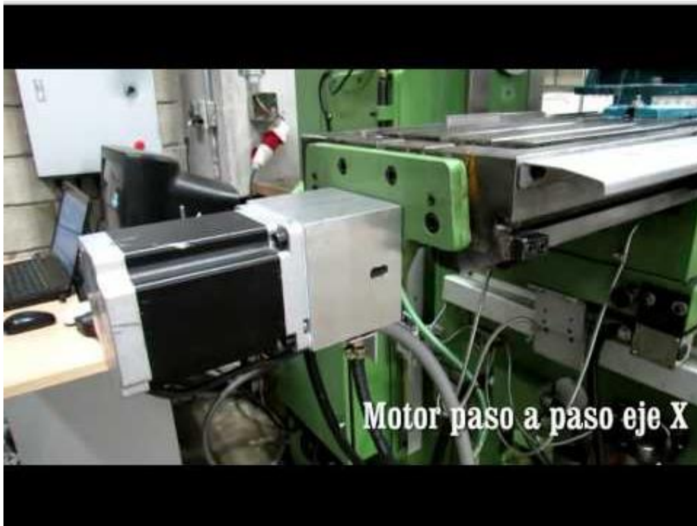
Anexo 7. Transmisión de movimiento a eje mediante acoplamiento.
