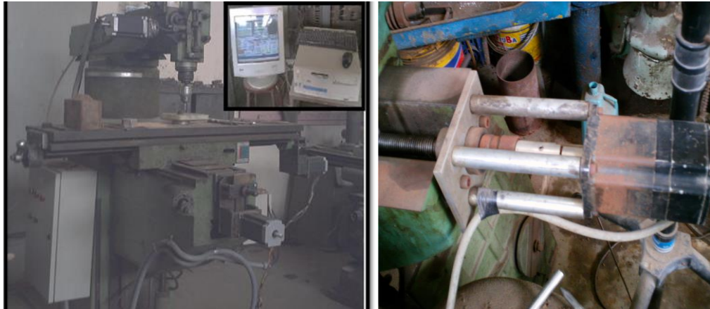
Figura 69. Montaje de motores en cada eje de la fresadora.
