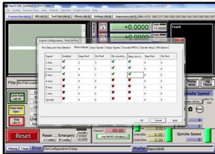
Figura 66. Configuración de los pines para la interfaz.
