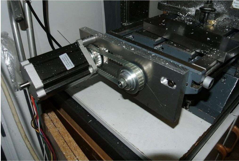
Anexo 6. Transmisión de movimiento a eje mediante polea.
