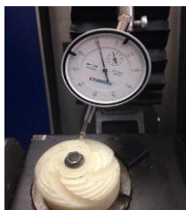
Figura 24. Medidas tomadas con el reloj comparador.
