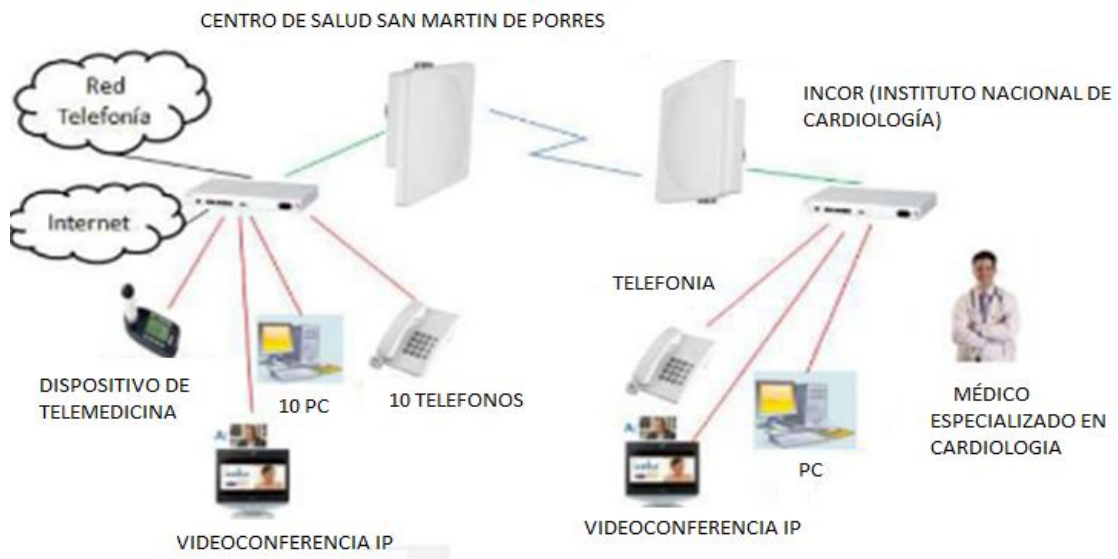
Figura 12: Esquema de la red de telemedicina
