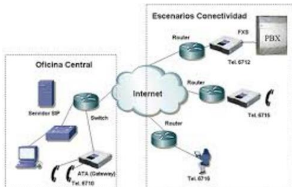
Figura 17: Diagrama de Red VOIP
