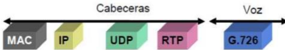
Figura 3: Gráfica de cabeceras y voz para el códec G.726
