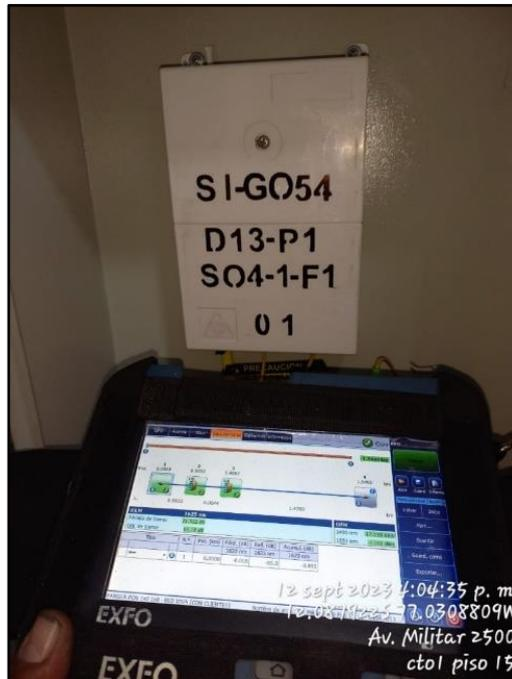
*Nota:* Medición de la CTO 01, instalada en el piso 15 del edificio. Elaboración propia.
