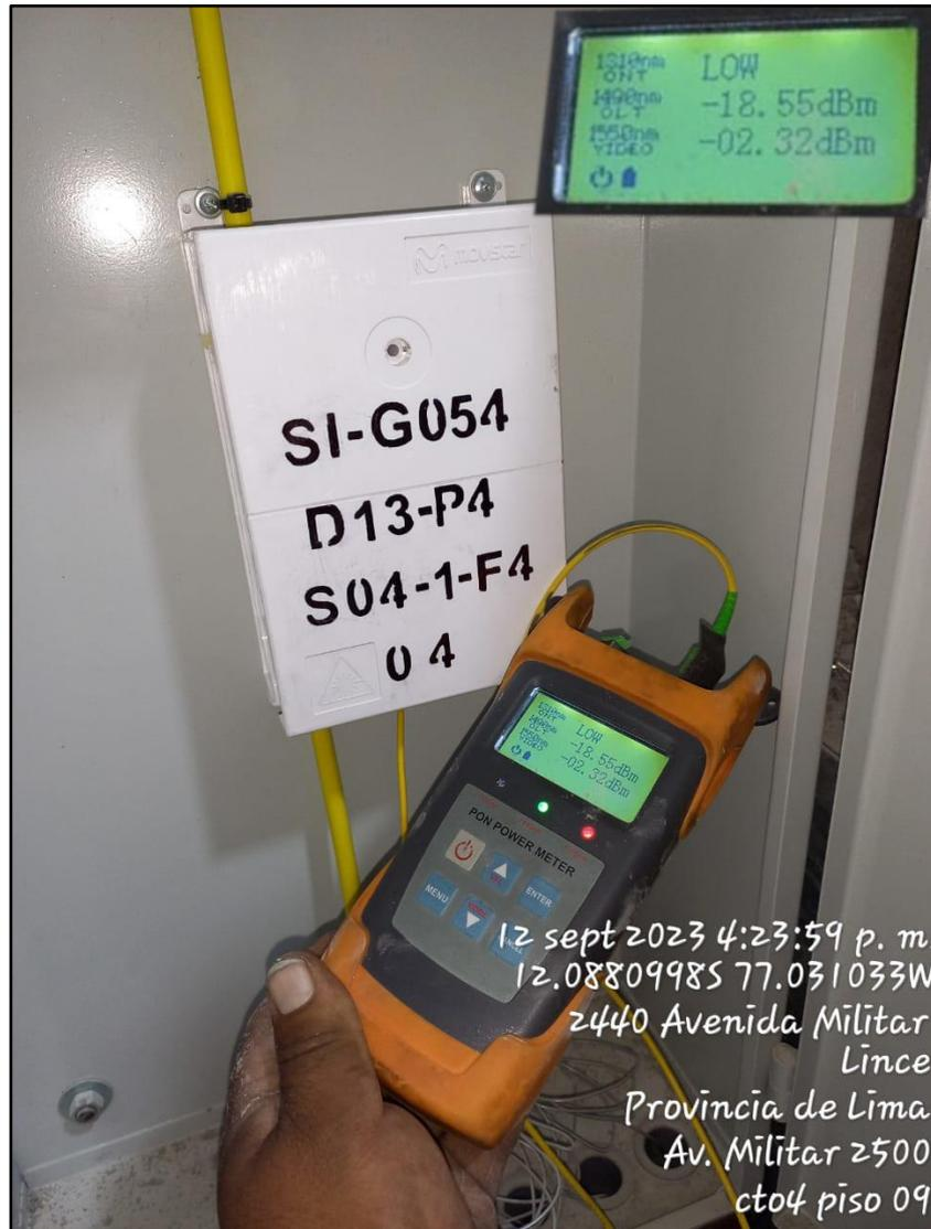
Nota: Medición de potencia óptica con PON Power Meter en el Piso 09, denominado CTO 04. Elaboración propia.
