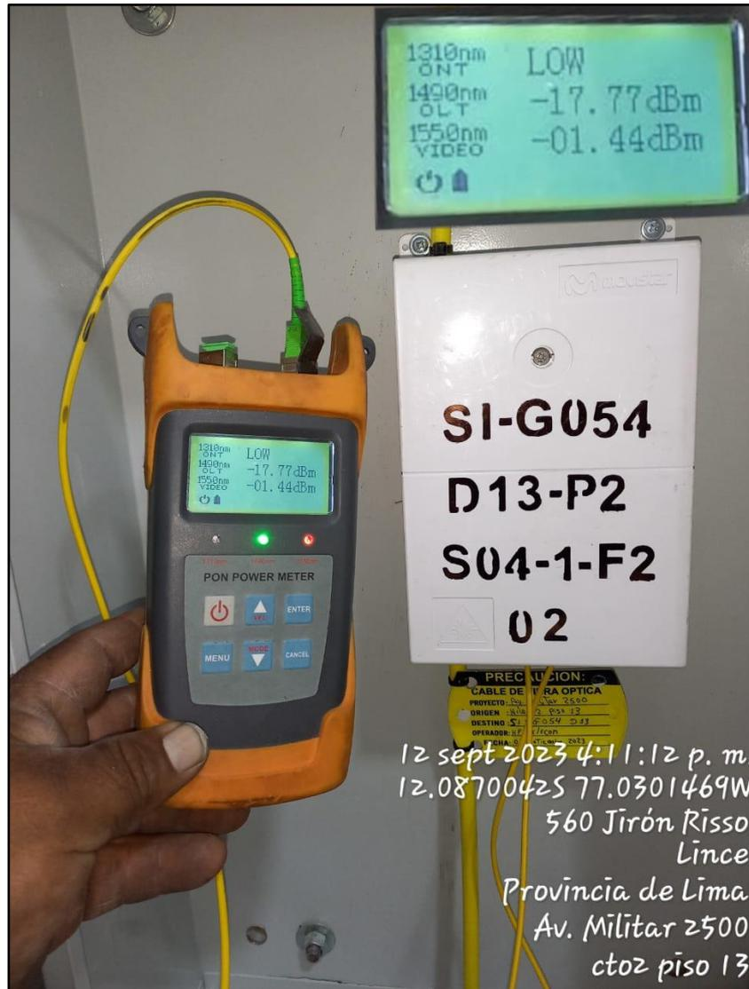
Nota: Medición de potencia óptica con PON Power Meter en el Piso 13, denominado CTO 02. Elaboración propia.
