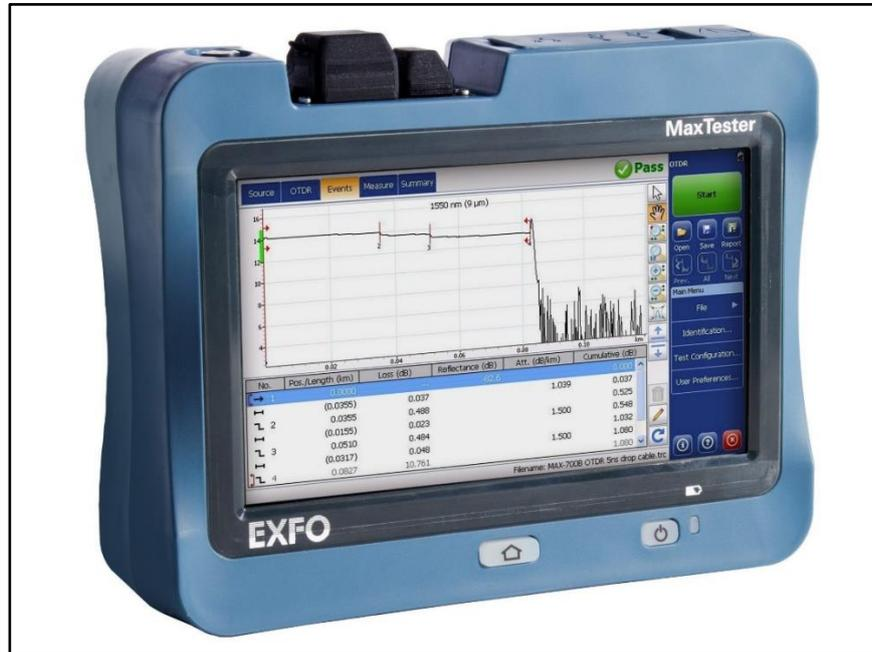
*Nota:* (EXFO, MaxTester 730C - PON/OTDR urbano, s.f.). MaxTester 730C, equipo usado para las pruebas reflectométricas.
