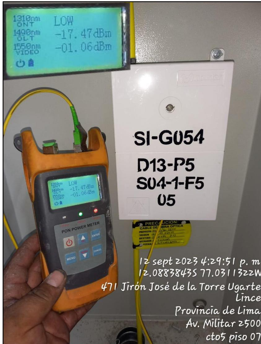
*Nota:* Medición de potencia óptica con PON Power Meter en el Piso 07, denominado CTO 05. Elaboración propia.
