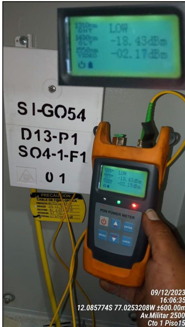
Nota: Medición de potencia óptica con PON Power Meter en el Piso 15, denominado CTO 01. Elaboración propia.
