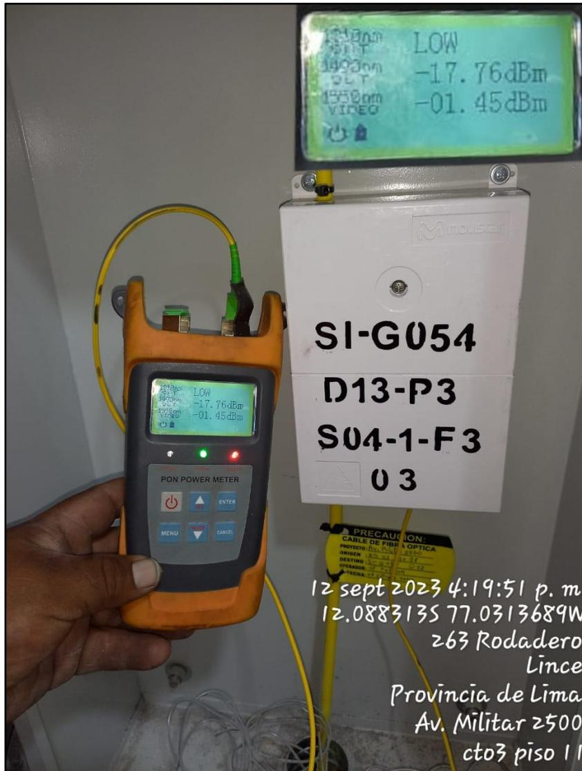
*Nota:* Medición de potencia óptica con PON Power Meter en el Piso 11, denominado CTO 03. Elaboración propia.
