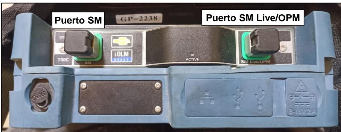
*Nota:* Imagen del equipo con los 2 puertos para realizar las pruebas de acuerdo con los requerimientos con fibra sin activar o con fibra activa. Elaboración propia.
