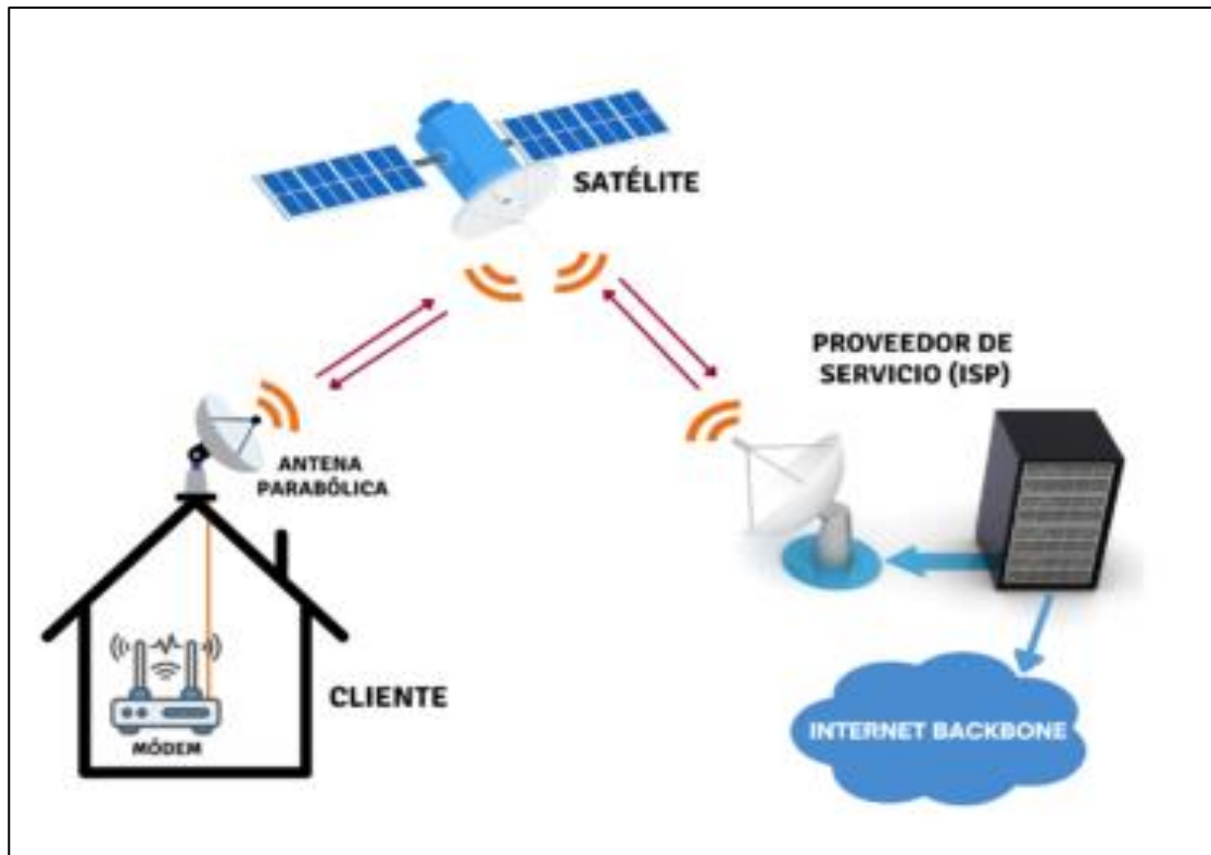
Figura 4 Elementos que conforman una Red Satelital
