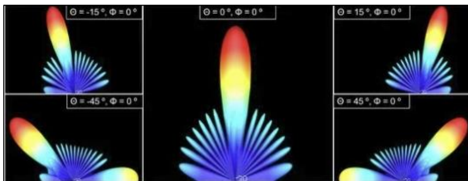
Figura 17 Diagrama de radiación de una antena usando la técnica beamforming.
