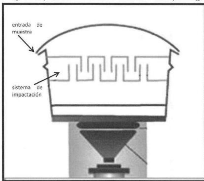
*Nota:* Modelo de funcionamiento de un equipo HI-VOL utilizado para la medición de parámetros de la Calidad del Aire. Pertenece a este sitio: <https://www.gob.pe/institucion/minam/normas-legales/363557-10-2019-minam>
