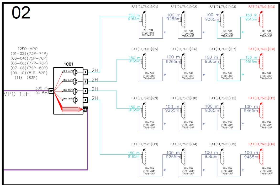
Figura 38. Diagrama del diseño, distribución del HUB BOX 01
