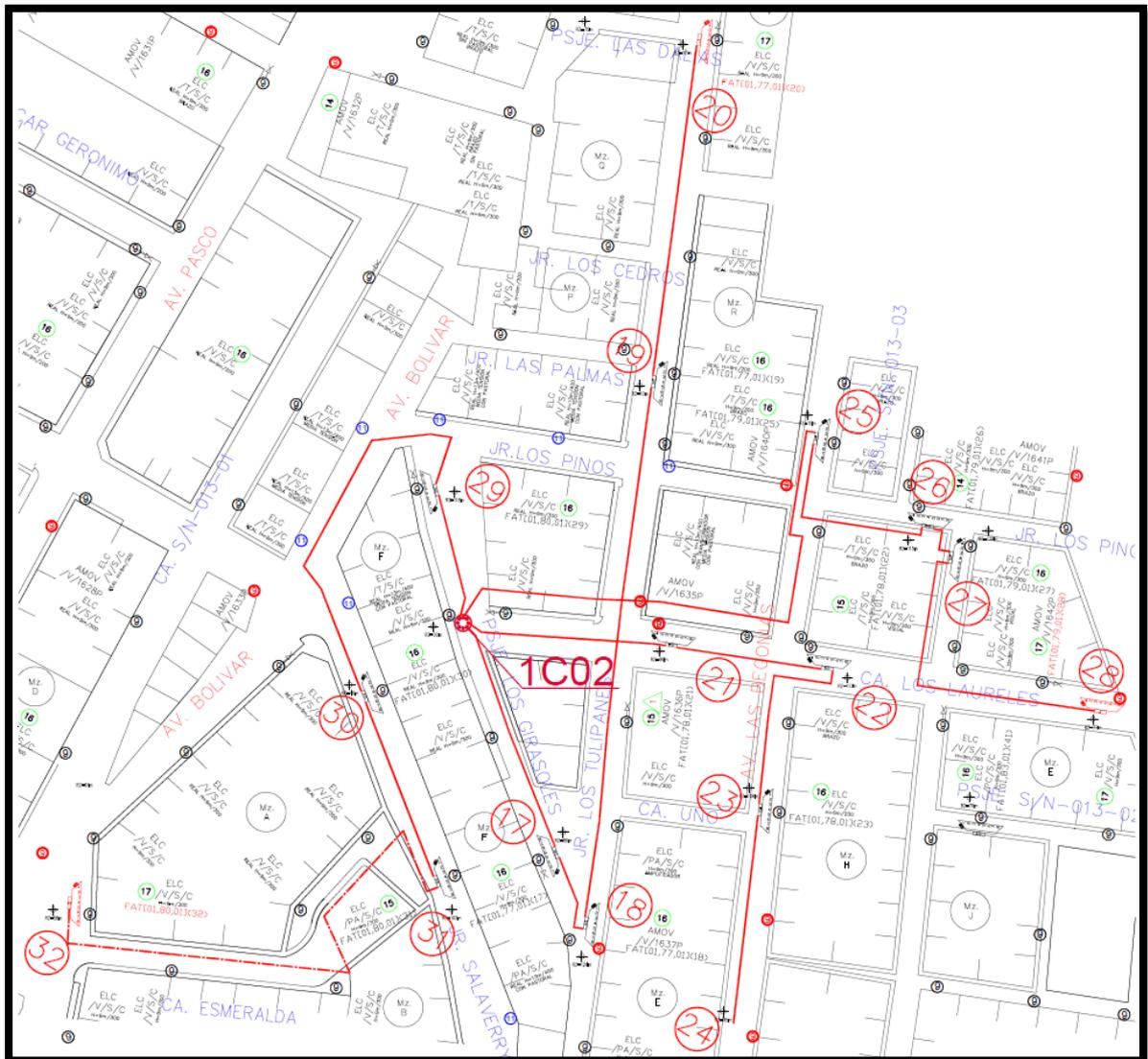
Figura 49. Despliegue de red del HUB BOX 02
