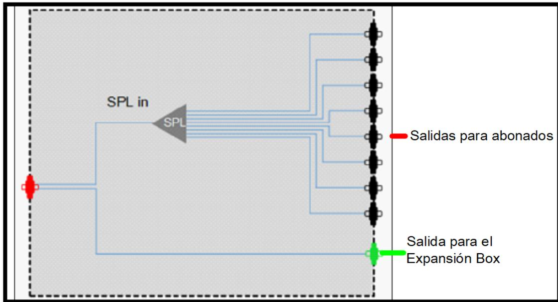
Figura 15. Splitter dentro del END BOX
