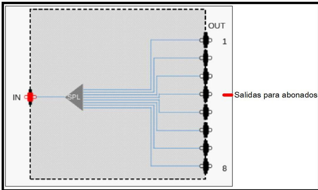
Figura 17. Splitter en EXPANSIÓN BOX
