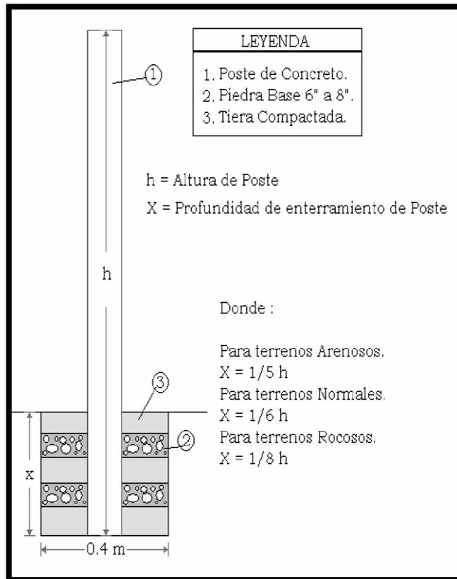
**Figura 42.** Criterios en la instalación de poste Fuente. Informe de permisos CLARO
