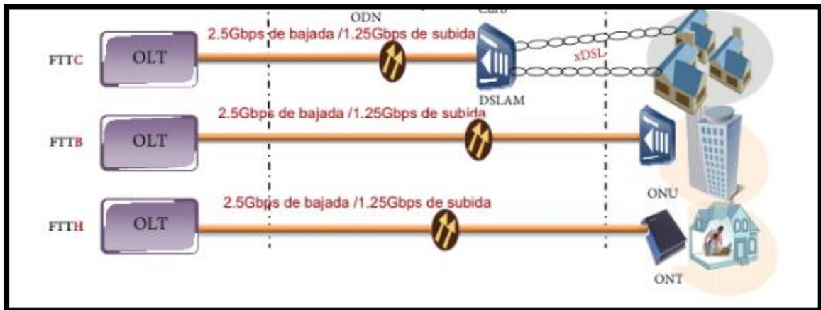
Figura 2. <sup>1</sup> Arquitectura de la red de acceso óptico
