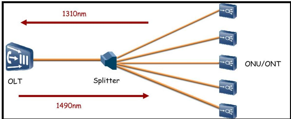
Figura 22. Multiplexación de datos
