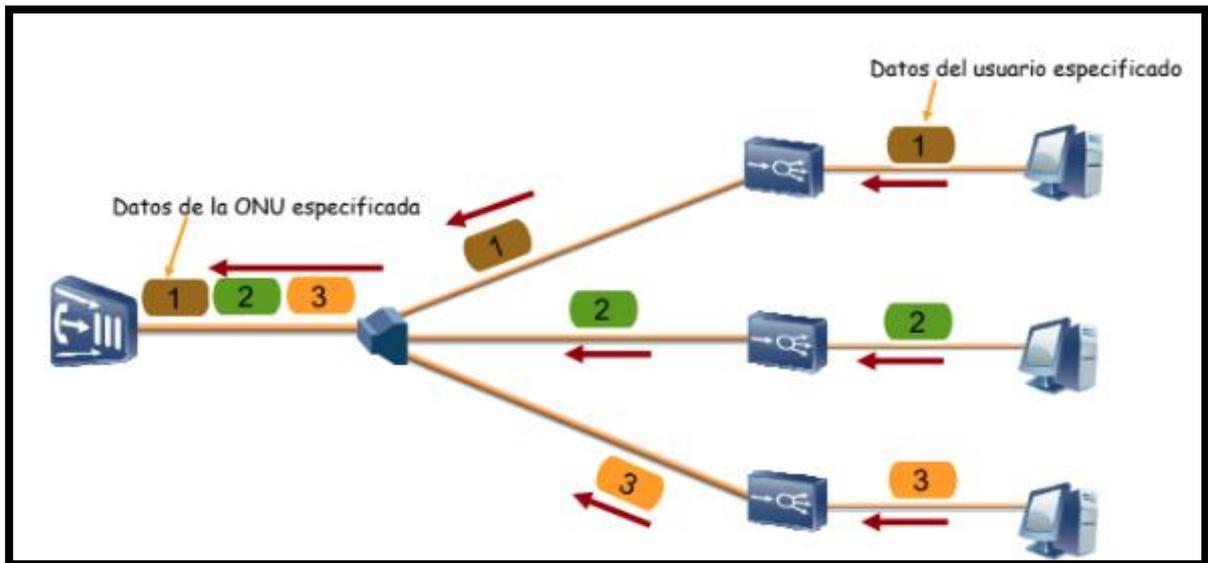
Figura 24. Principio de subida
