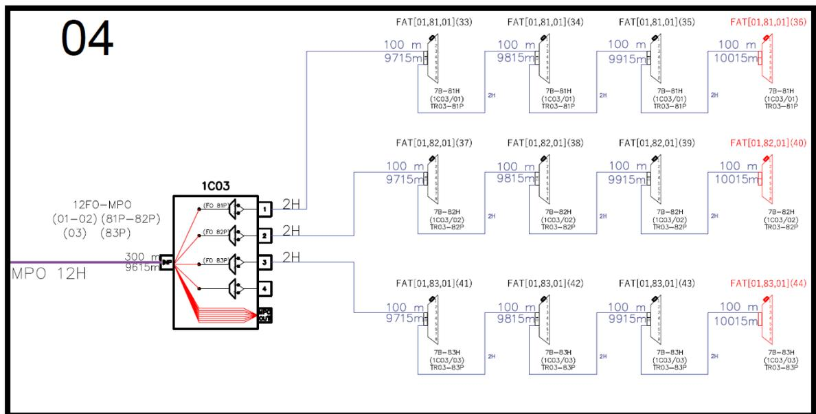
Figura 40. Diagrama del diseño, distribución del HUB BOX 03
