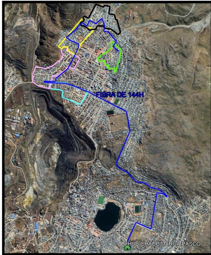
Figura 30. Fibra de ADSS de 144 hilos de la troncal 03
