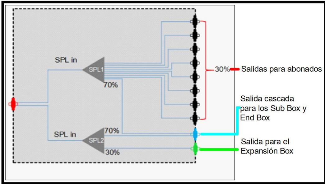
Figura 13. Splitter dentro del SUB BOX
