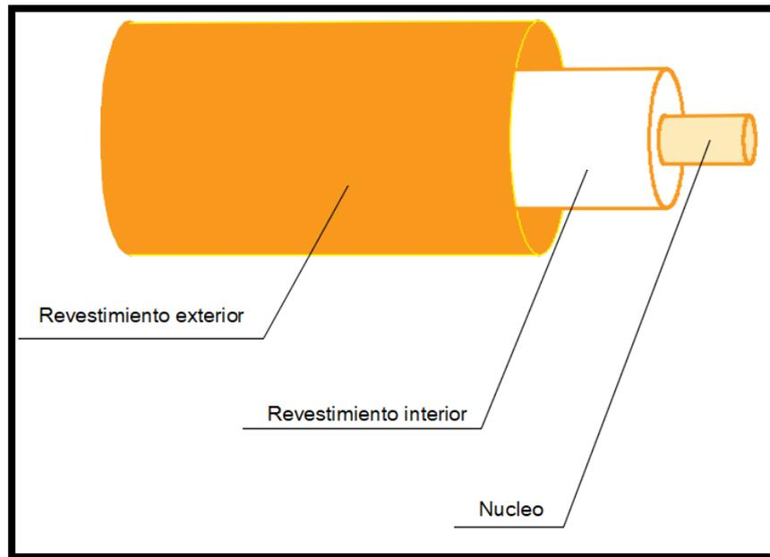
Figura 3. Hilo de fibra óptica según la Empresa Corning
