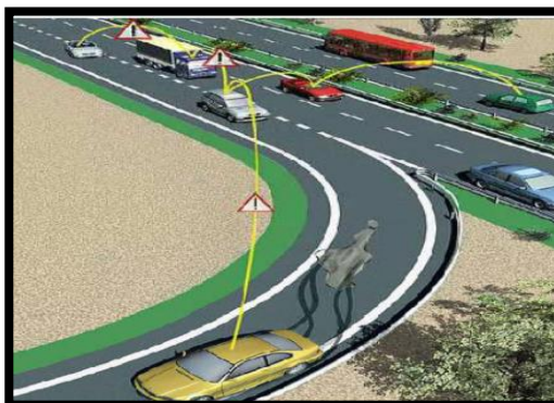
Figura 18. Aviso de elemento o punto peligroso en la carretera (CLIFF)
