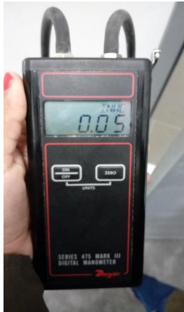
Figura 16 – Valores obtenidos en pruebas de presión 0.05 pulg/Ca Fuente “Fotografía de instalación de bases de concreto en proyecto Torre del Parque”
