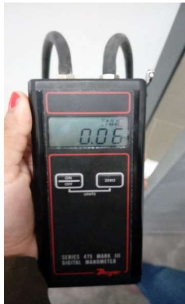
Figura 15 – Valores obtenidos en pruebas de presión 0.06 pulg/Ca
