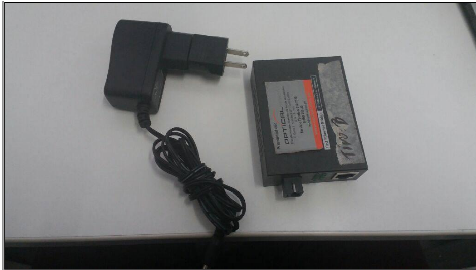
Figura N° 3.33 "Media Converter" Fuente: Elaboración propia.
