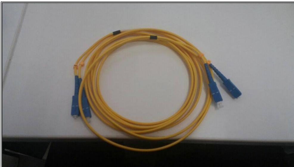
Figura N° 3.32 "Patch cord" Fuente: Elaboración propia.
