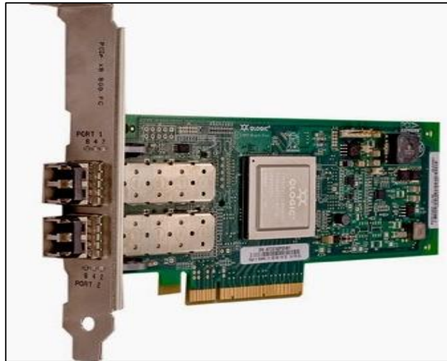
Figura 20. Adaptador HBA. Fuente: Data center de GMD.
