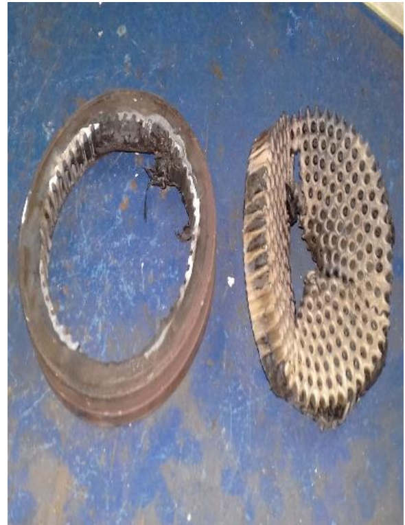
Ocasionó la ruptura del filtro
