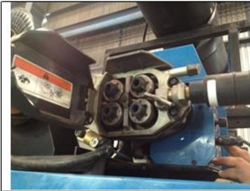
Foto 3. Ajuste del micro alambre para el proceso GMAW
