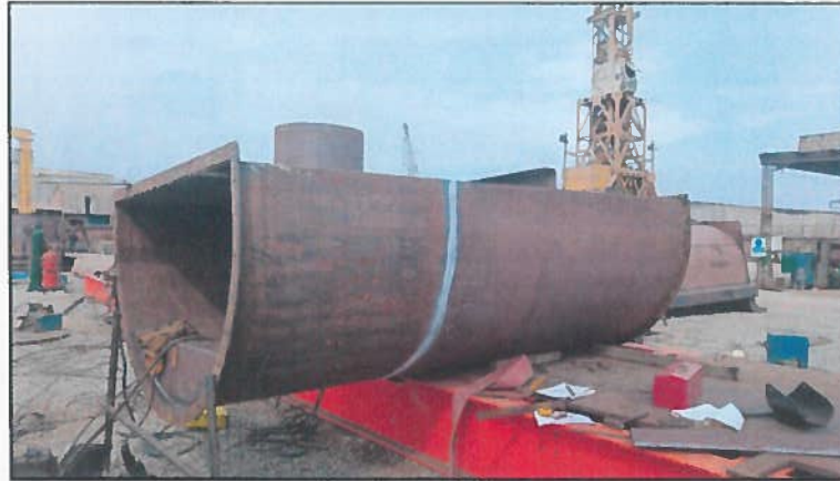
Fotografía N°1: Se observa la cara exterior de la junta soldada, en la cual se aplicó el revelador MR 70 como medio de contraste (blanco)
