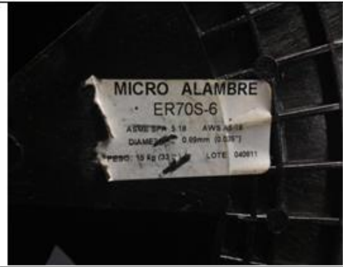
Foto 4. Verificación de las características del micro alambre
