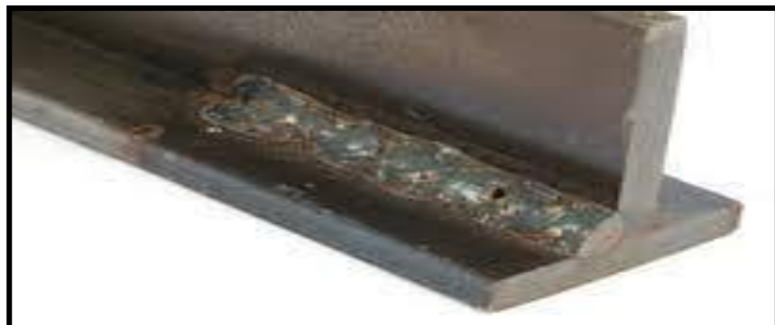
Figura 2.30. Porosidad de soldadura
