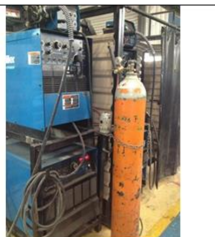
Foto 8. Equipo completo del proceso GMAW
