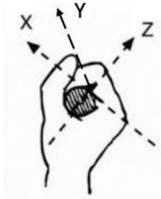
Figura 27. Direcciones de los ejes de vibración en el sistema mano - brazo
