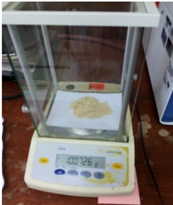
Figura 6. Pesado de la muestra de moringa para la colocación en el equipo Soxhlet.
